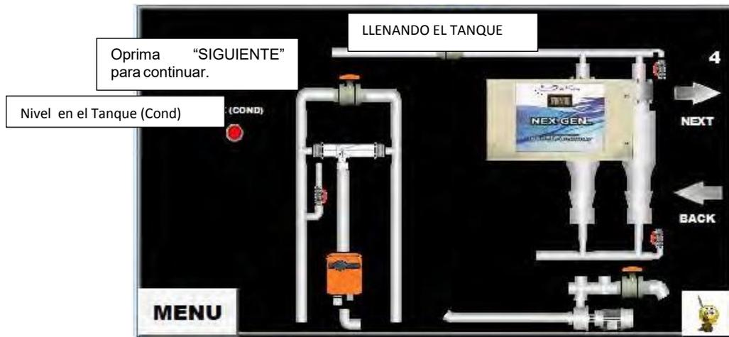
Cierre la Válvula 3, Válvula de Llenado de Tanque
