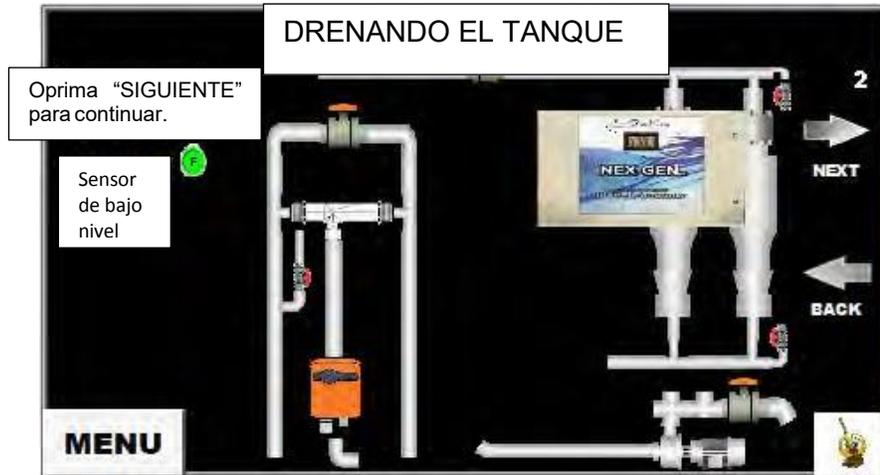
Cuando el tanque esté vacío, aparecerá en la pantalla TANQUE VACIO.
