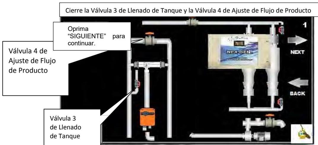
**PASO 2** – Durante este paso se iniciará la Bomba Booster y se vaciará el tanque de producto. Cuando el tanque esté vacío, el Sensor VERDE de Nivel Bajo se pondrá ROJO.
