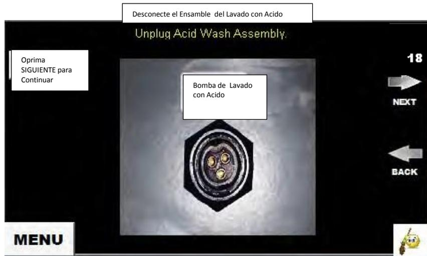
**PASO 19** – Desconecte el Acoplamiento de Entrada y Salida del Lavado con Acido de las Válvulas de Entrada y Salida del Lavado con Acido.
