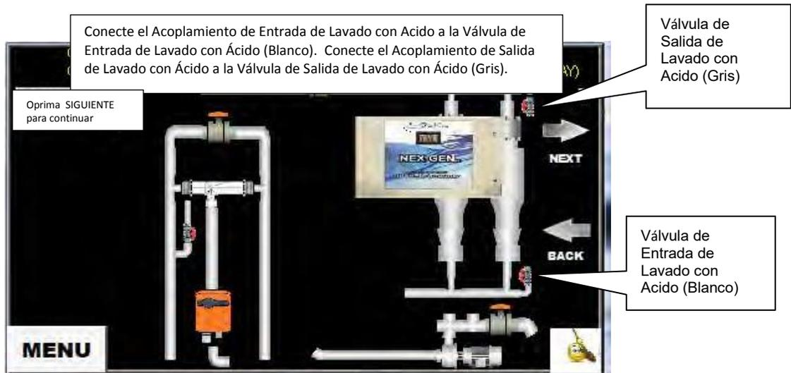
Conecte el Acoplamiento de Entrada de Lavado con Acido a la Válvula de Entrada de Lavado con Ácido (Blanco). Conecte el Acoplamiento de Salida de Lavado con Ácido a la Válvula de Salida de Lavado con Ácido (Gris).
