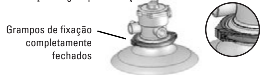
FIGURA 4 - Instalação do grampo de fixação
